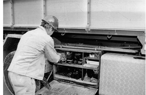
1 Die Zurr- und Anschlagmittel werden in geeigneten Behältern mitgeführt. So sind sie immer griffbereit.
