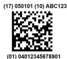
Abbildung 5.1.1-6. GS1 DataMatrix Code
