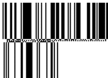
Abbildung 5.5.2.3.2-1. GS1 DataBar Expanded Stacked
