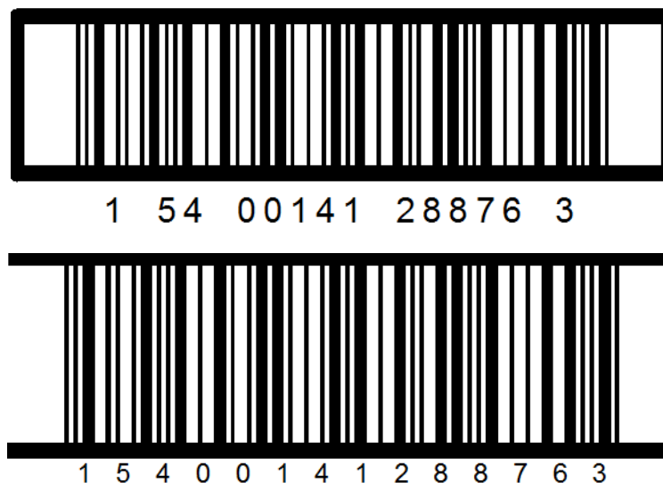
Abbildung 5.3.2.4-1. Beispiele von Trägerbalken
