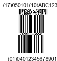
Abbildung 5.1.1-5. GS1 DataBar Stacked Omnidirectional Strichcode mit Composite Component
