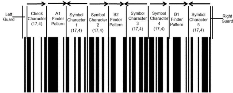
Abbildung 5.5.2.3-1. GS1 DataBar Expanded Struktur
