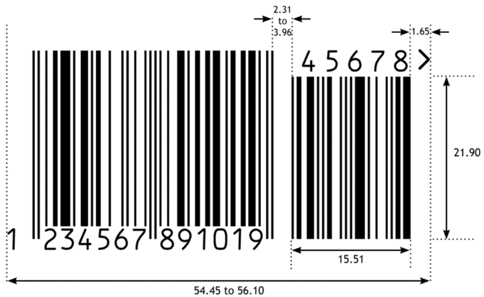
Abbildung 5.2.6.6-6. EAN-13 Strichcode mit fünfstelligem Zusatzsymbol
