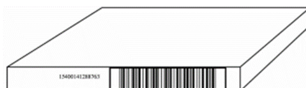
Abbildung 6.7.1.3-2. Symbolplatzierung auf flachen Behältern
