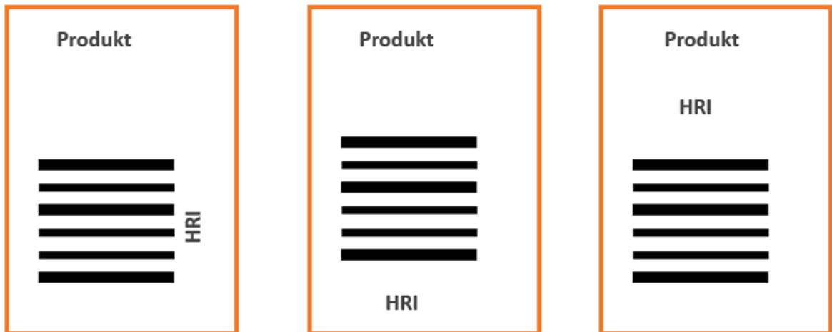
Abbildung 4.14-3. Platzierung der Klarschriftzeile bei Strichcodes in Leiterausrichtung
