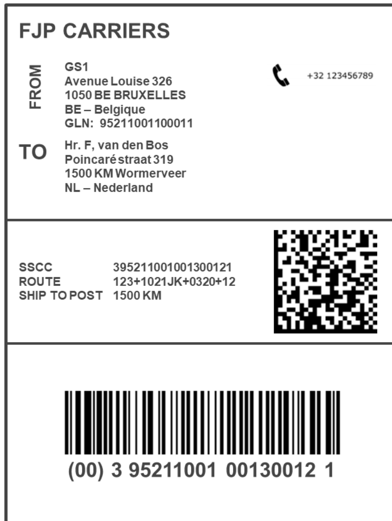
Abbildung 6.6.5-8. Etikett mit GS1 DataMatrix mit enthaltenen Lieferinstruktionen
