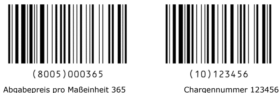
Abbildung 7.8.6.2-2. In einem GS1-128 Symbol verkettete Daten
