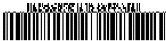
Abbildung 5.11.8-9. GS1-128 Symbol mit einer 4 spaltigen CC-A Komponente
