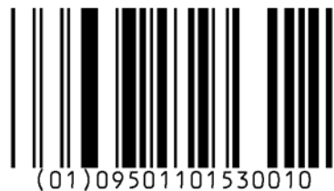
Abbildung 5.5.2.1.1-1. GS1 DataBar Omnidirectional
