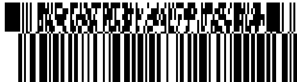
Abbildung 5.11.2-2. GS1-128 Composite Symbol mit CC-C
