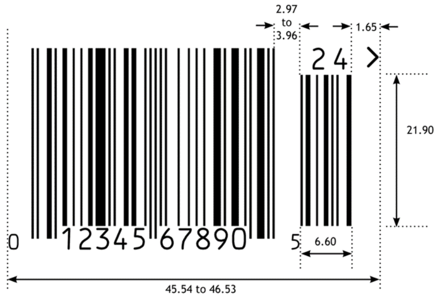
Abbildung 5.2.6.6-5. UPC-A Strichcode mit zweistelligem Zusatzsymbol
