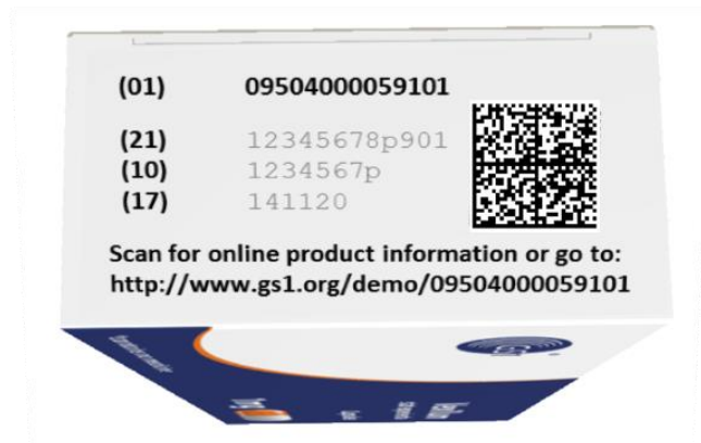
Abbildung 4.14.1-1. Bevorzugtes HRI Format für GS1 DataMatrix
