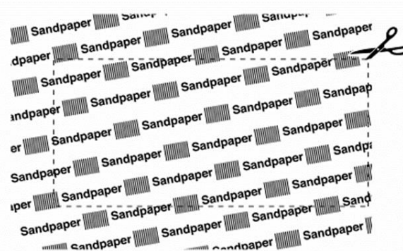
Abbildung 6.3.3.7-2. Symbolplatzierung auf Endlosverpackungen
