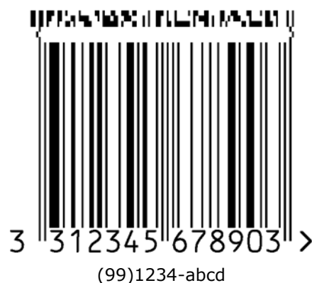
Abbildung 5.11.8-1. EAN-13 Symbol mit einer 4-spaltigen CC-A Komponente
