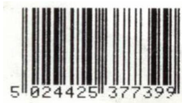
Abbildung 5.12.5.12-1. Symbol mit Problemen bei der Kantenvermessung
